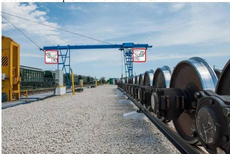
Рисунок 3 - Система видеоаналитики по обнаружению работников и посторонних предметов в габарите движения козлового крана
