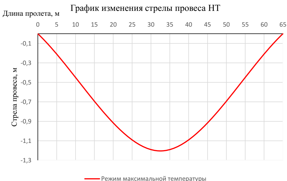
Рисунок 3 – График изменения стрелы провеса несущего троса в режимах минимальной и максимальной температуры
