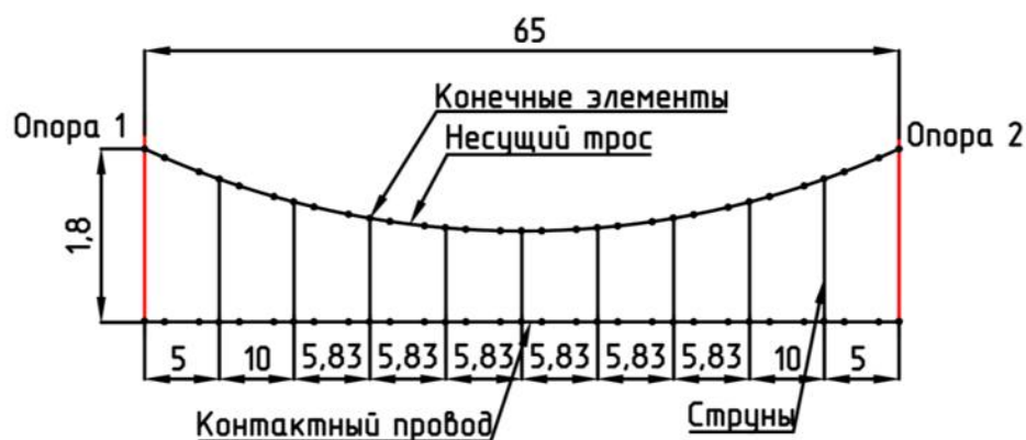
Рисунок 4 – Расчетная геометрия пролета между опорами контактной сети
