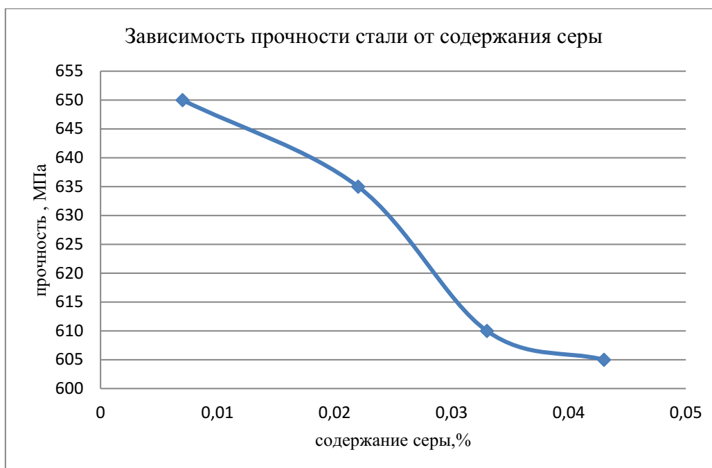
Рисунок 2 - Зависимость прочности стали от содержания серы
