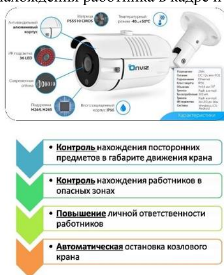
Рисунок 3 - Система видеоаналитики по обнаружению работников и посторонних предметов в габарите движения козлового крана
